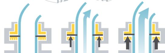
1. En phase de démarrage, le disque frein du canon repose sur des pastilles frein inférieures
