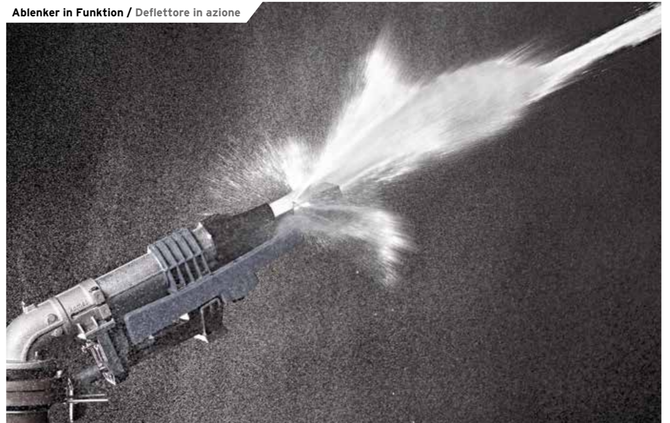
Ablenker in Funktion / Deflettore in azione
