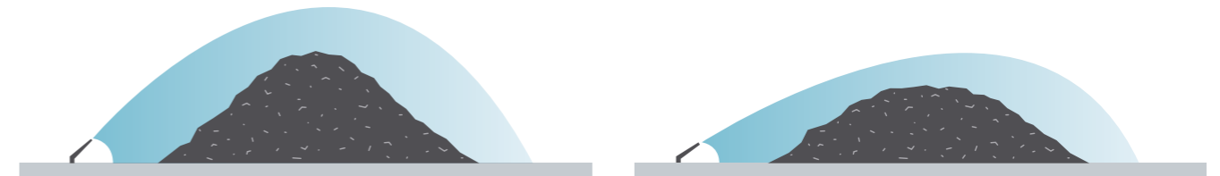
Verschiedene Strahlwinkel-Einstellungen um sich der Schutthalden-Konfiguration anzupassen Diverse regolazioni dell'angolo di traiettoria, in base alle caratteristiche del cumulo.
